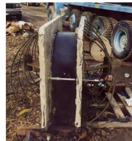
Wykorzystanie komory Osterberga do badania modułu pobocznic cylindra dzielonego
